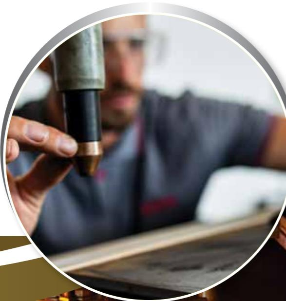
Gasno sečenje metala spada u termičke postupke, pri čemu se radna temperatura postiže sagorevanjem gorivog gasa acetilena. Sagorevanjem ovog gasa dobija se deo topote kojom se radna temperatura održava, a značajan deo topote se dobija sagorevanjem metala koji se reže, što je bitna prednost ovog postupka.
